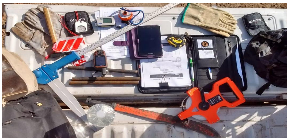
Figura 11 Ejemplo de instrumental para supervisión de parcelas remediables a campo: forcípula, hipsómetro, brújula, cinta métrica, GPS, planillas de campo.
