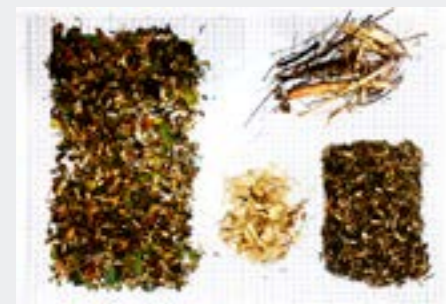
Ensayo de tamaño de partícula o granulometría. RP chipeados de la localidad de Camilo Aldao, Córdoba, pertenecientes a especies arbóreas y arbustivas con hojas.
