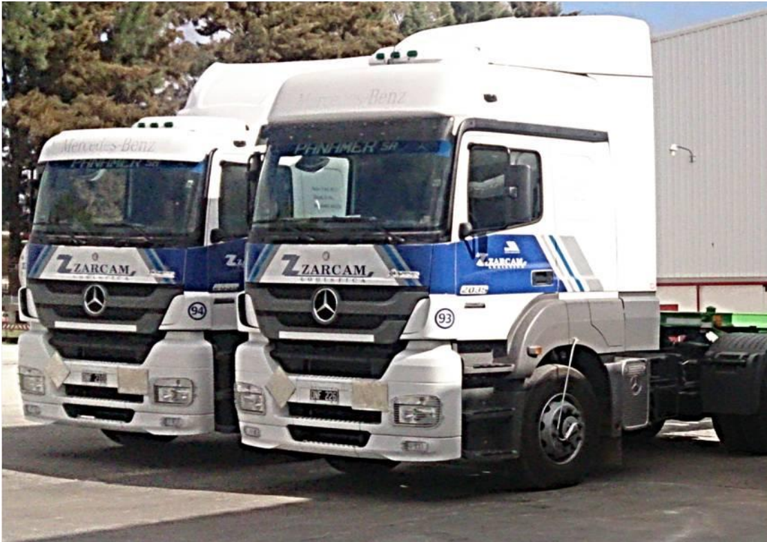
Zarcam. Implementación de deflectores aerodinámicos en cabina y sistema de monitoreo y calibración de presión de neumáticos.
