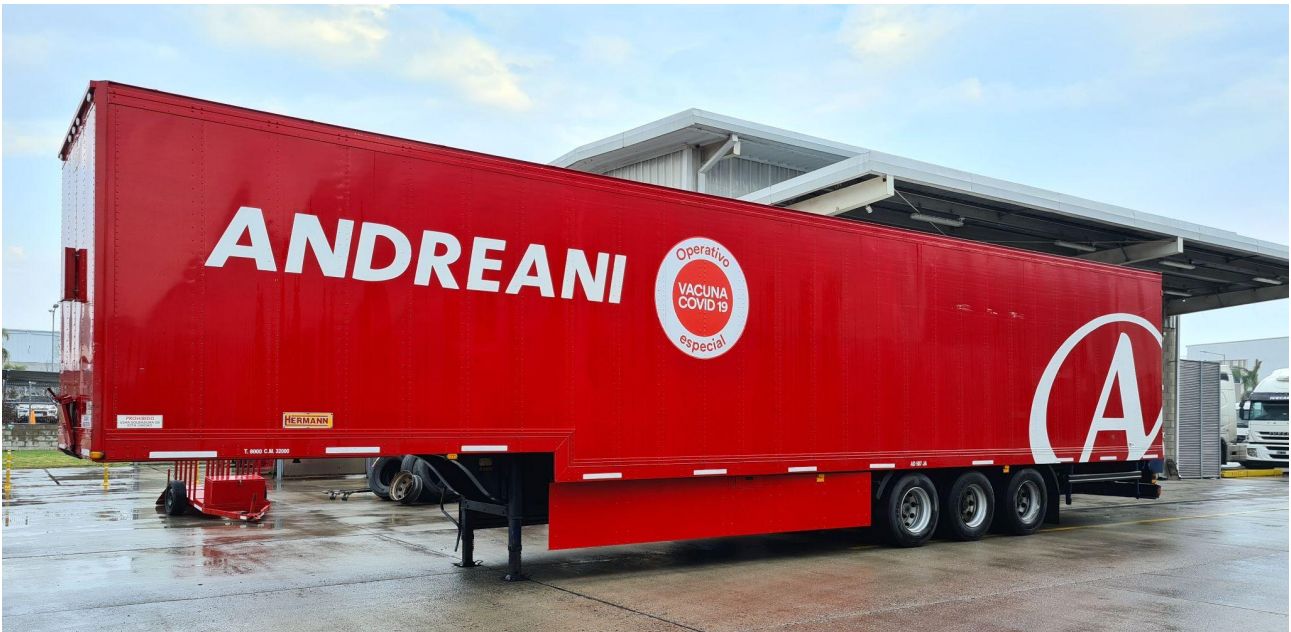
Andreani: utilización de paneles deflectores aerodinámicos bajo los semirremolques.
