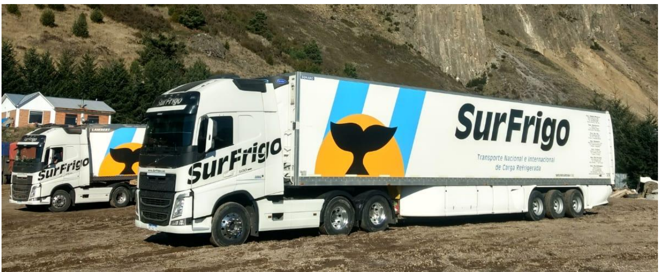
SurFrigo: deflectores aerodinámicos laterales en cabina, cubre tanque, deflectores traseros y bajo semirremolque y reducción de espacio entre tractor y semirremolque.
